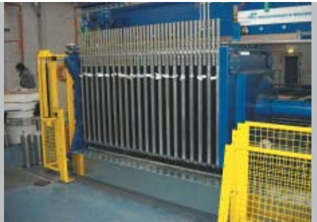
Filterpresse mit Membran- und Kombinationskammerplatten 1200 x 1200 mm. Filtration von Metallpigmenten mit Lösungsmitteln
