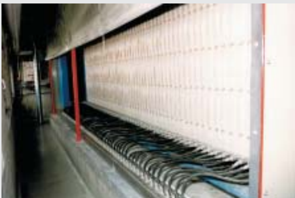
Filterpresse für Kuchentrocknung mit Membran-kammerplatten 1200 x 1200 mm
