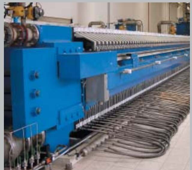
Filterpresse mit Füll- und Kompressions-Kammerplatten 1500 x 1500 mm, Auspreßdruck 5,0 MPa (50 bar)
