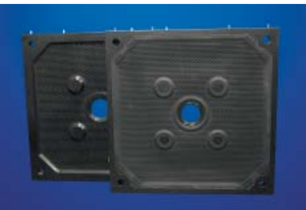
Membran- und Kombinationskammerplatte 1200 x 1200 mm. Die PVDF-Platte und EPDM Membrane sind elektrisch ableitend ausgerüstet. Einsatz bei extrem hohen Temperaturen und/oder starker chemischer Belastung in Metallurgie, Chemie etc.
